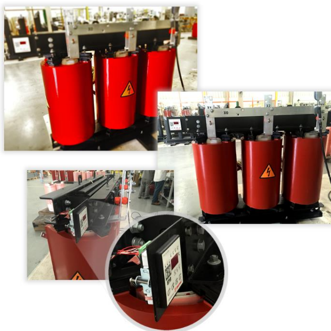
Figura 10 – EP3 instalado em um Transformador do Tipo-seco de média tensão.
