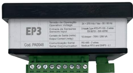
Figura 5 – Localização da etiqueta de dados técnicos.
