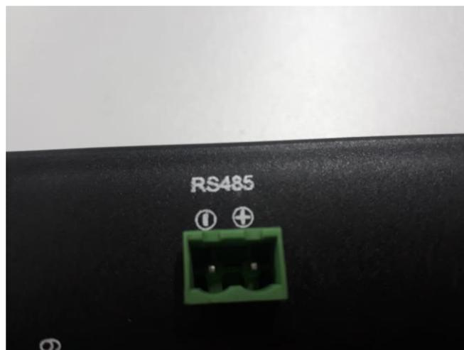
*Figura 9 – Fotografia da identificação RS-485 em um EP3 da Electron do Brasil*
