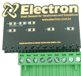
**Cartão referência para sinal de PT-100:** Este acessório foi desenvolvido para se realizar a verificação do valor de temperatura exibido por equipamentos com entrada de sensores RTD PT-100 de 3 fios. É constituído por resistores de precisão que enviam um sinal de resistência fixo e constante equivalente para seleção entre 3 diferentes faixas, 0 °C (100 Ohms), 26 °C (110,9 Ohms) e 200 °C (175,86 Ohms).
