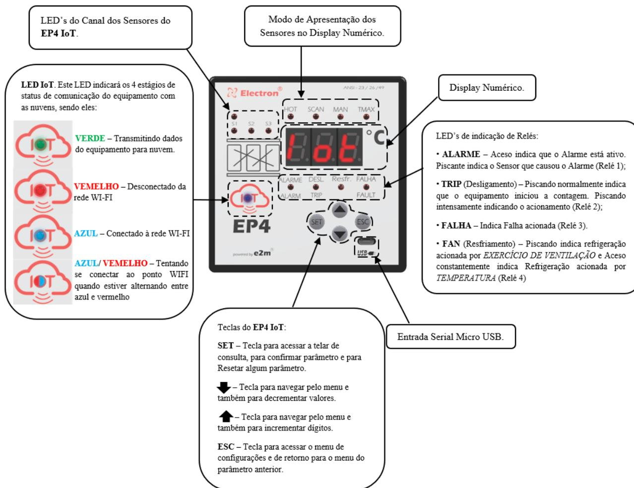
Fig. 8 – Frontal EP4-IoT com entrada serial.
