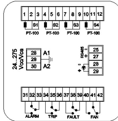
Fig. 2 – Diagrama de conexão do EP4-IoT IoT
