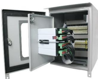
**Painel de porta dupla para uso externo/outdoor:** Caixa para uso externo com porta dupla para montagem de instrumentos, acessórios e passagem de fios de comando e potência do transformador de potência. A porta externa contém visor de vidro com proteção contra raios UV para visualização das grandezas medidas pelo monitor de temperatura e o painel contém pintura especial que é resistente contra intempéries e seu grau de proteção é IP 55, conforme NBR IEC 60529:2017.
