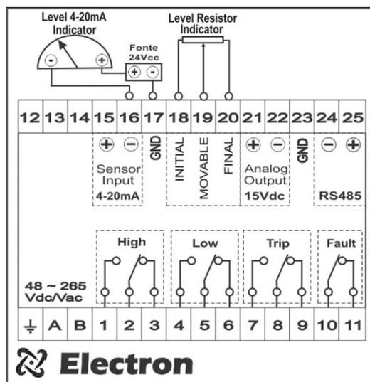
Figura 1 – Diagramas de conexões
