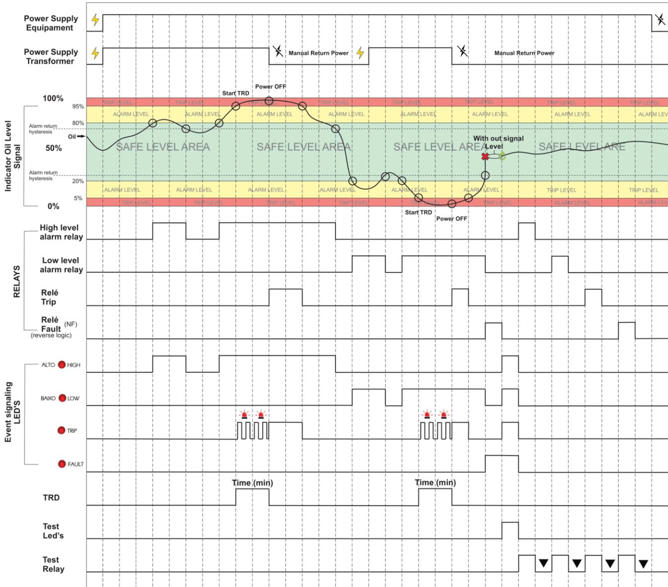
Figura 4 – Gráfico de Funcionamento
