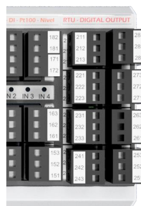
Figura 20 - Ilustração de módulo saídas digitais a Relé SPDT NAF
