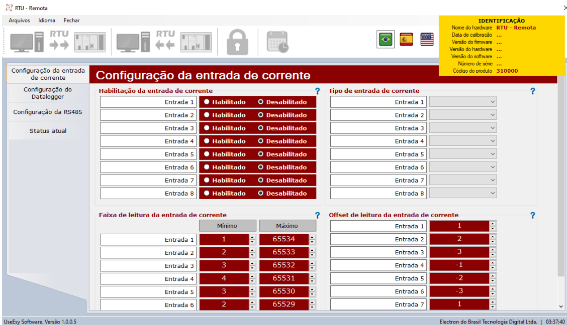
Figura 47 - Tela inicial do Software de configuração da RTU
