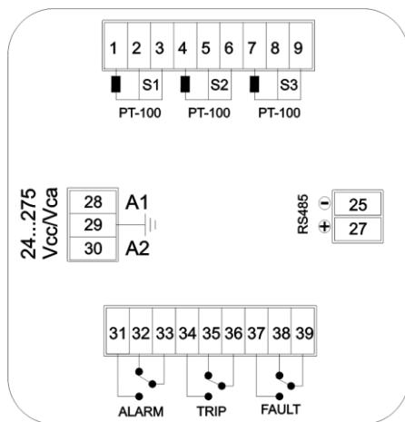
Fig. 2 – Diagrama de conexão do EP3-IoT IoT
