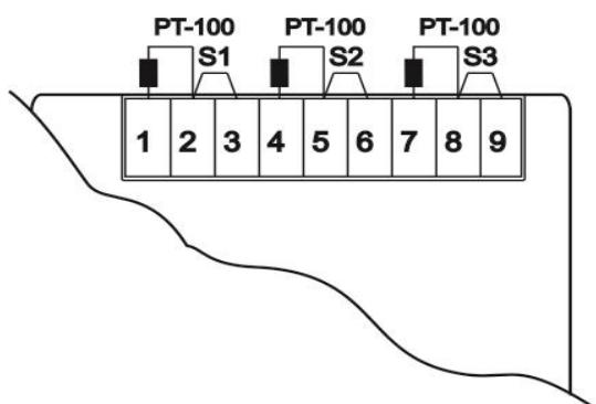
Fig. 3 – Diagrama Sensores de conexão com 2 fios
