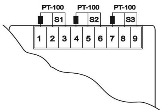
Fig. 4 – Diagrama Sensores de conexão com 3 fios
