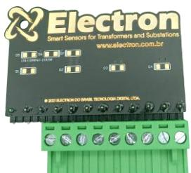
**Cartão referência para sinal de PT-100:** Este acessório foi desenvolvido para se realizar a verificação do valor de temperatura exibido por equipamentos com entrada de sensores RTD PT-100 de 3 fios. É constituído por resistores de precisão que enviam um sinal de resistência fixo e constante equivalente para seleção entre 3 diferentes faixas, 0 °C (100 Ohms), 26 °C (110,9 Ohms) e 200 °C (175,86 Ohms).
