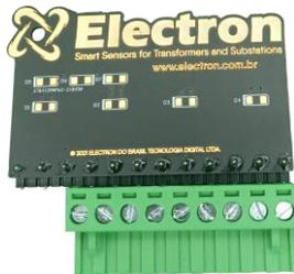
**Tarjeta de referencia de señal PT-100:** Este accesorio fue desarrollado para verificar el valor de temperatura mostrado por el equipo con entrada de sensor RTD de 3 hilos PT-100. Consiste en resistencias de precisión que envían una señal de resistencia fija y constante equivalente para la selección entre 3 rangos diferentes, 0 °C (100 ohmios), 26 °C (110,9 ohmios) y 200 °C (175,86 ohmios).
