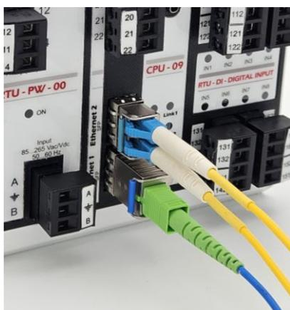
Figura 5 – 1 Fibra Óptica dupla + 1 Fibra Óptica Bidirecional
