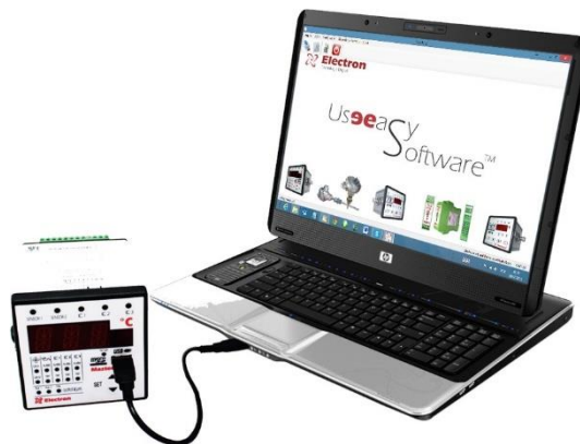
ENTRADA USB PARA PARAMETRIZAÇÃO
