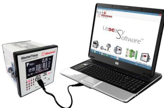
Fig. 2 – Entrada USB para Parametrização via Software UseEasy
