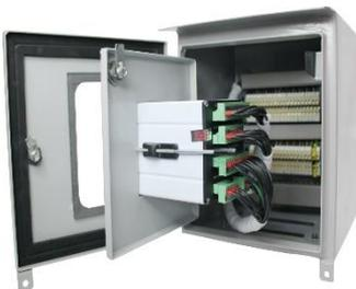
**Painel de porta dupla para uso externo/outdoor:** Caixa para uso externo com porta dupla para montagem de instrumentos, acessórios e passagem de fios de comando e potência do transformador de potência. A porta externa contém visor de vidro com proteção contra raios UV para visualização das grandezas medidas pelo monitor de temperatura e o painel contém pintura especial que é resistente contra intempéries e seu grau de proteção é IP 55.
